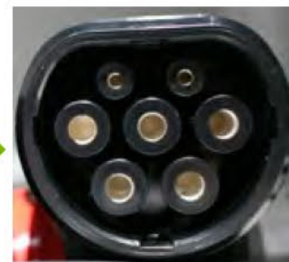
J3068->53kW-99kW(ac) 120kW-320kW (DC6)
